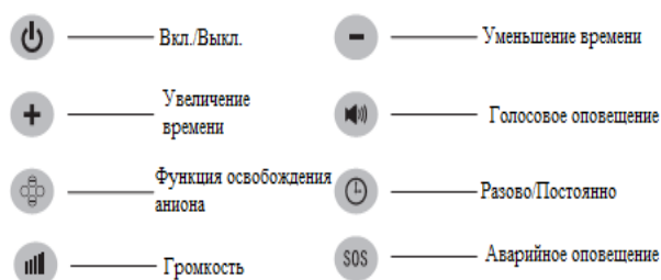
Рис.6. Схема пульта дистанционного управления
